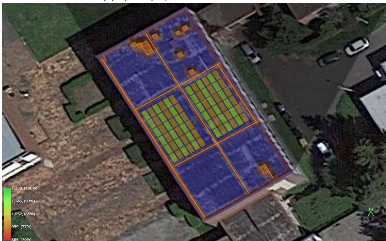
Obrázek č. 4.9.4.4: Schéma efektivity výroby elektřiny FV panelů
