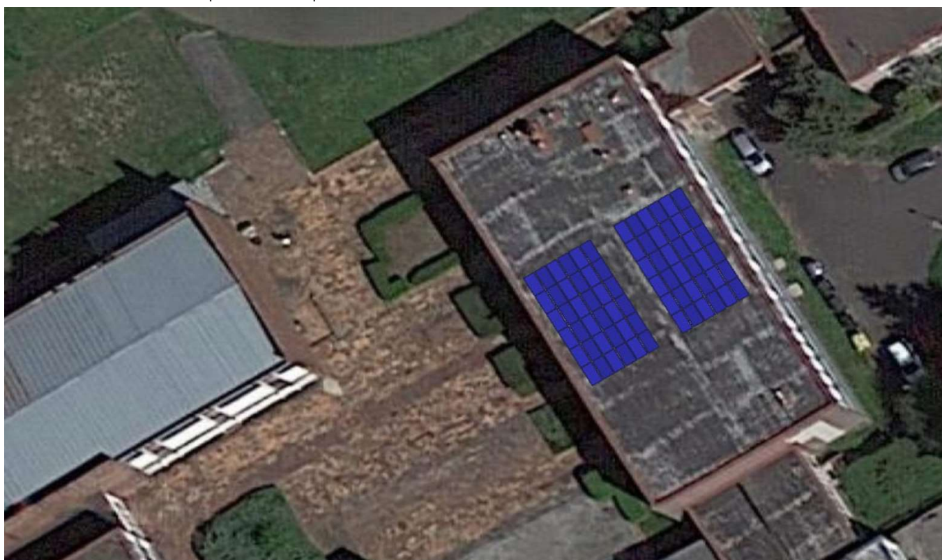
Obrázek č. 4.9.4.1: Rozložení panelů/Plocha pro umístění FVE
