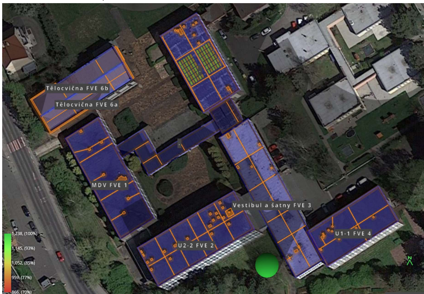
Obrázek č. 4.9.4.2: Zastínění FV panelů
